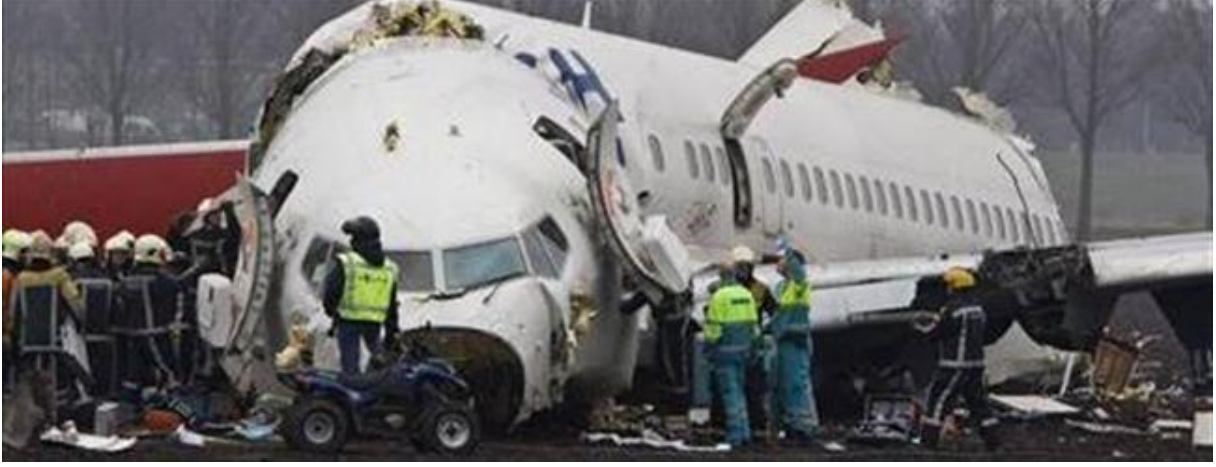
2009'da 127 yolcu 7 mürettebatın hayatını kaybettiği THY Amsterdam kazasının nedenlerinden biri: Altimetre arızası
